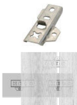
Mit dem Terrassenverbinder DILA2 wird eine zuverlässige und verdeckt liegende Befestigung aus Edelstahl errichtet. Durch eine Gleit- und Fixpunktmontage wird natürliches Quellen und Schwinden optimal und kontrolliert ausgeglichen.
