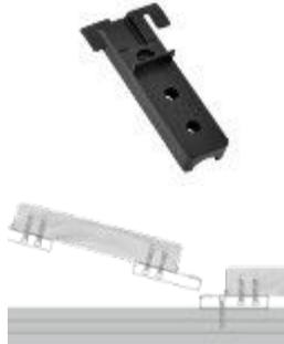
Der verdeckt liegende Terrassenverbinder garantiert eine sehr einfache und schnelle Montage für Terrassendielen aus Holz. Der 10 mm starke Terrassenverbinder sorgt für eine maximale Lastaufnahme und gewährleistet eine perfekte Hinterlüftung und konstruktiven Schutz der Bauteile.
